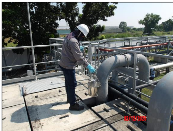
รูปที่ 3-3 การเก็บตัวอย่างคุณภาพน้ำทิ้ง
